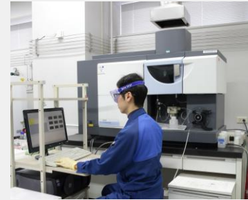
誘導結合プラズマ(ICP) 発光を用いた分析
